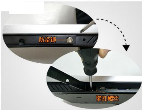
1、首先用钥匙打开防盗锁，然后将壁挂螺丝拧出
